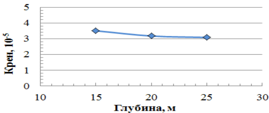
Рис. 11. Крен сооружения при различной глубине защитного экрана
