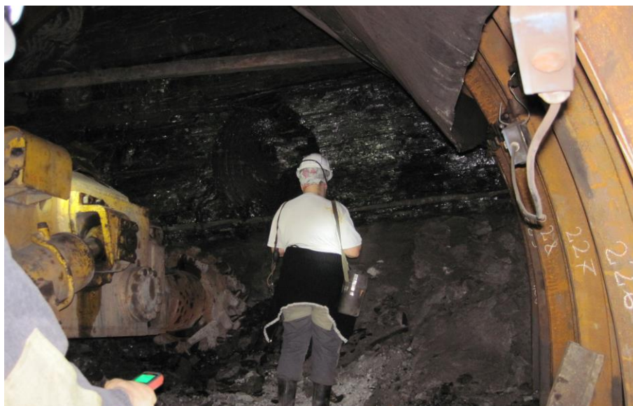
Рис. 1. Примеры проходческого забоя: а – полевая выработка (по «пустой» породе); б – смешанный забой (с отдельной комбайновой выемкой)
