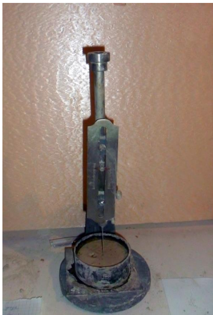
Рис. 1. Общий вид эксперимента по определению сроков схватывания смеси с помощью прибора Вика
