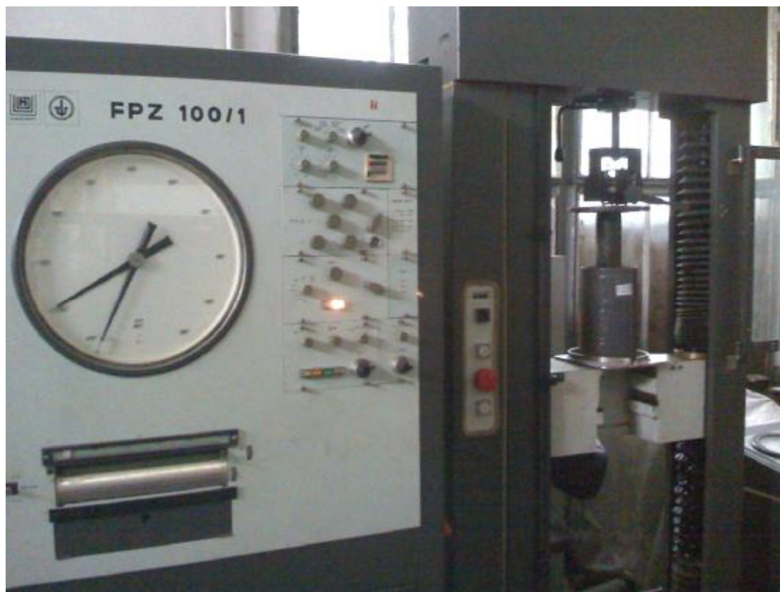
Рис. 2.3. Фото лабораторной установки (пресс 5 т, пресс 10 т)
