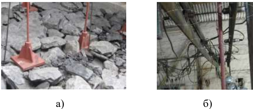
Рис. 4. Загальний вигляд апаратури контролю геомеханічної ситуації гірського масиву: а – основа реперного датчика, б – оптичні датчики зміщення
