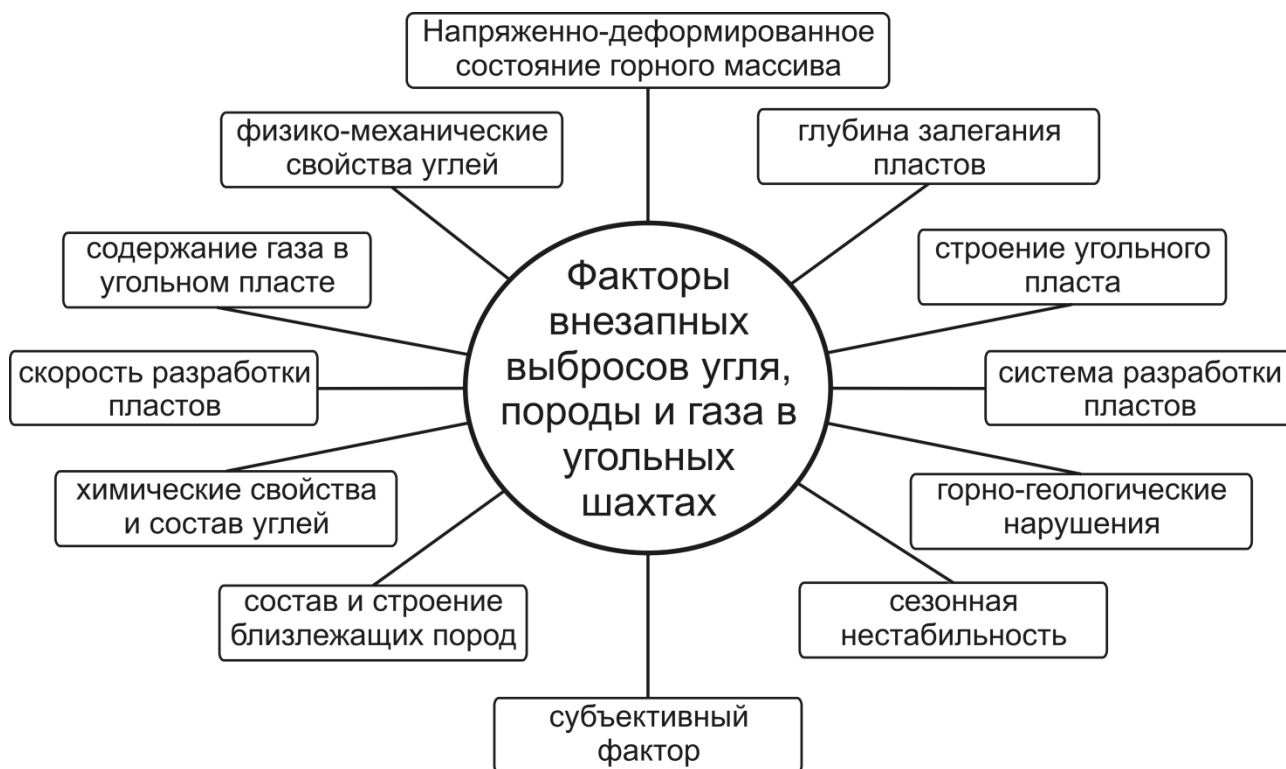
Рис. 1. Факторы выбросоопасности в угольных шахтах
