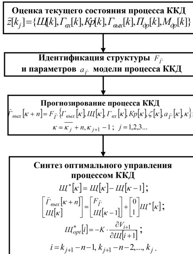
Рис. 3. Процедуры алгоритма синтеза адаптивного оптимального управления процессом ККД по ФОР с прогнозирующей моделью
