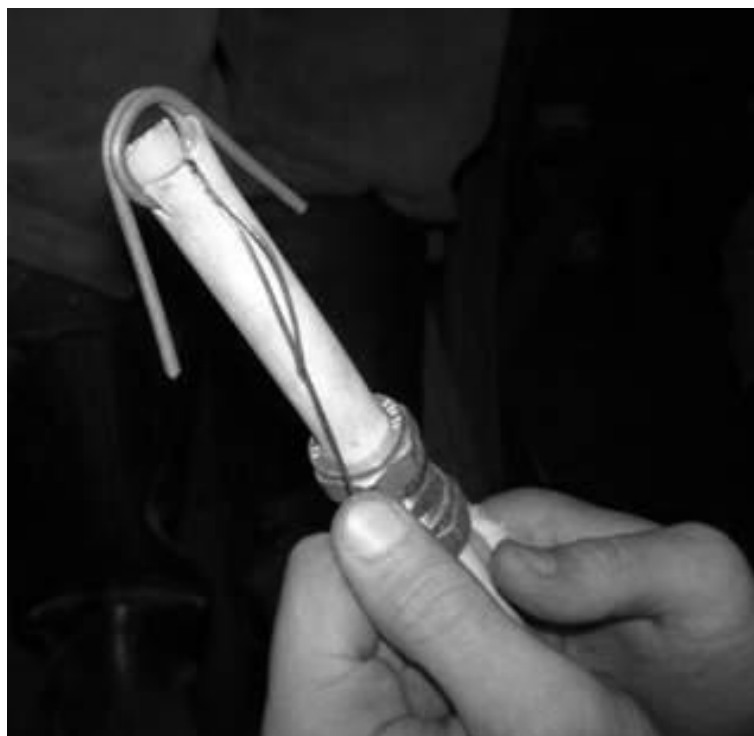
Рис. 3.7. Установка якоря в досыльник
