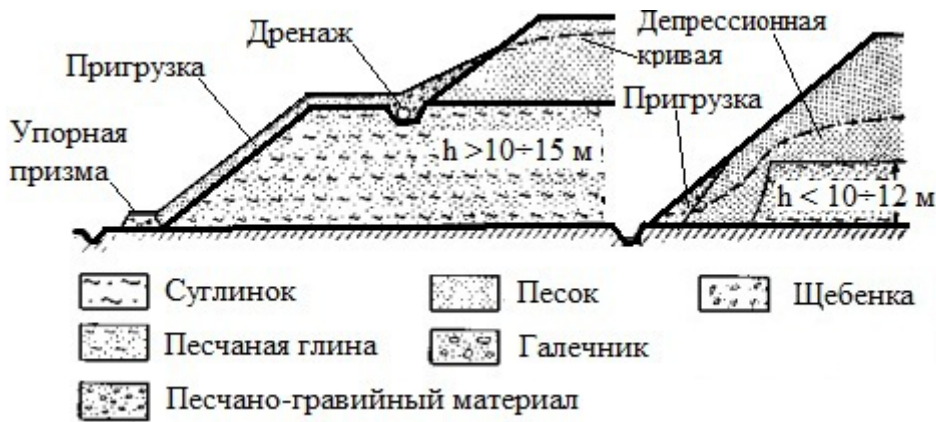
Рис. 5. Виды пригрузок песчано-глинистых откосов
