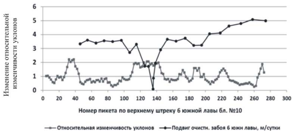
Рис.7. Изменение относительной удельной изменчивости уклонов угольного пласта и скорости подвигания очистного забоя 6-ой южной лавы блока №10 на различных пикетах участковой выработки
