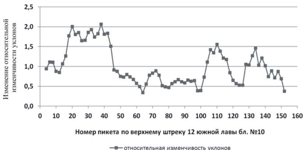
Рис.9. Изменение относительной удельной изменчивости уклонов угольного пласта и подготовленного к отработке участка 12-ой южной лавы блока №10 на различных пикетах участковой выработки
