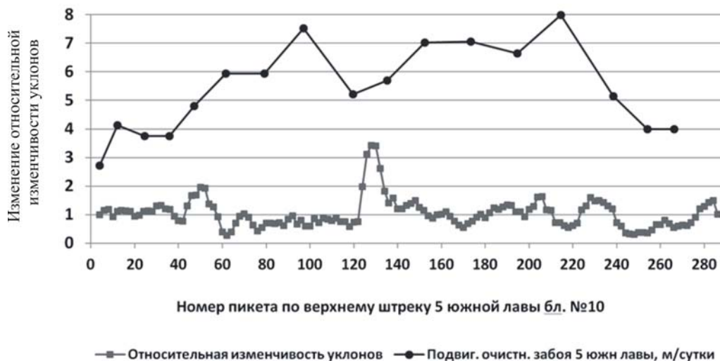
Рис.8. Изменение относительной удельной изменчивости уклонов угольного пласта и скорости подвигания очистного забоя 5-ой южной лавы блока №10 на различных пикетах участковой выработки
