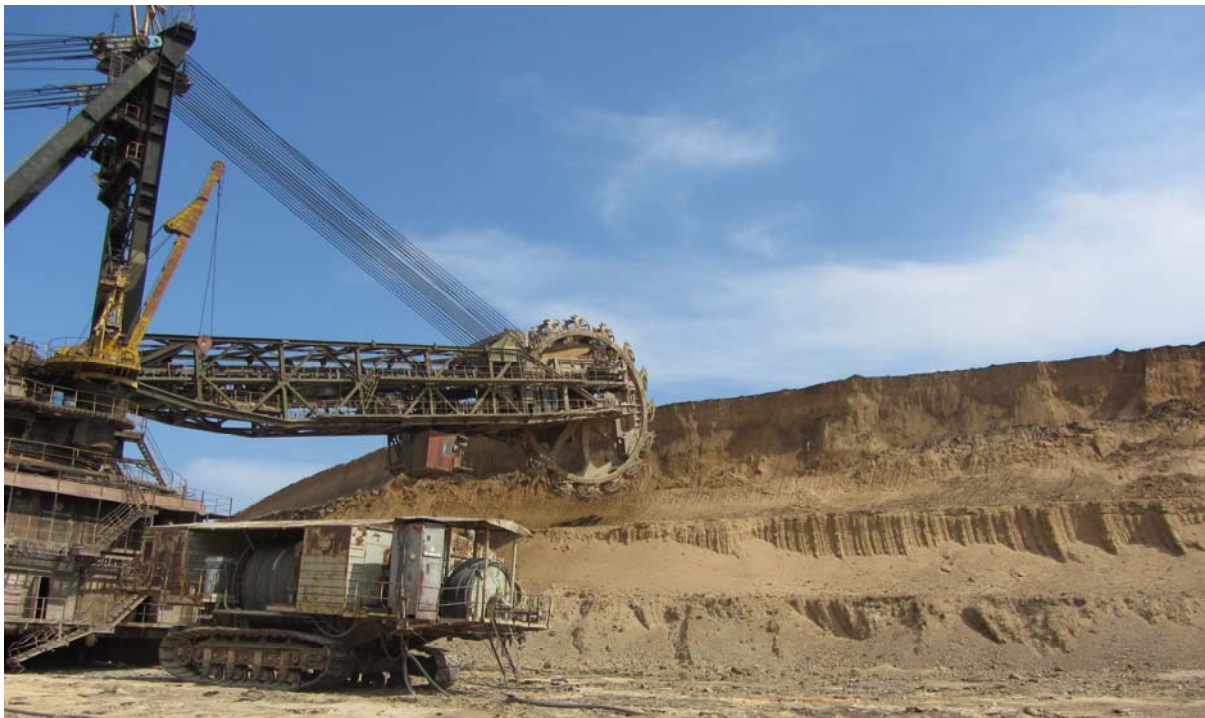
Рис. 2. Работа роторного экскаватора в Шевченковском карьере ОАО «Орджоникидзевский ГОК».
