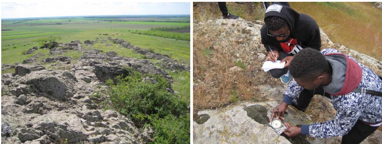
Рис. 3. Выходы железистых кварцитов, геологический памятник природы «Корсак-Могила». Определение элементов залегания горных пород с помощью горного компаса.
