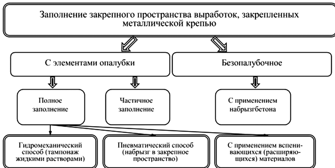
Рис. 1. Классификация технологии возведения крепи с заполнением закрепного пространства твердеющими составами
