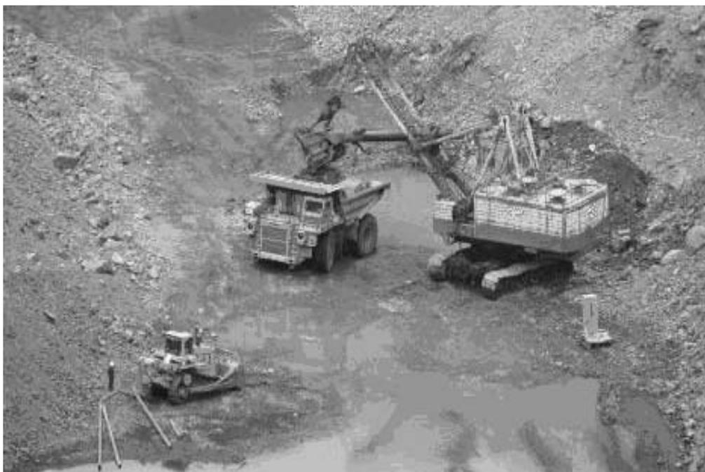
**Рис. 2** – Послойная проходка траншеи механической лопатой
