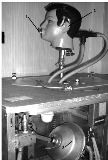
Рис. 5. Стенд для определения перепада давления на СИЗОД: 1 – трубка; 2 – манекен головы; 3 – дыхальная машина
