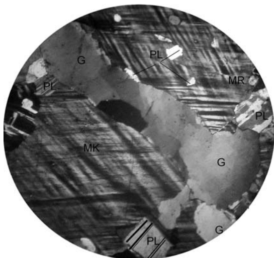
Рис. 7. Графическая структура леопардового пегматита Е-11: МК-микроклин, G - ихтиоглипты кварца разных систем (разновременное угасание), PL – плагноклаз. Увеличение 45 x . Николи+
