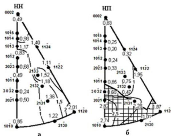
Рисунок 1. Экспериментальные обратные полюсные фигуры сплава ZE10
