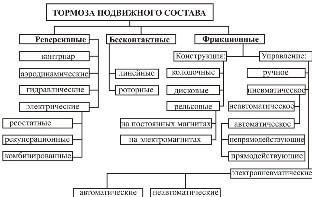
Рис. 1.1. Классификация тормозов по способу торможения и конструкции
