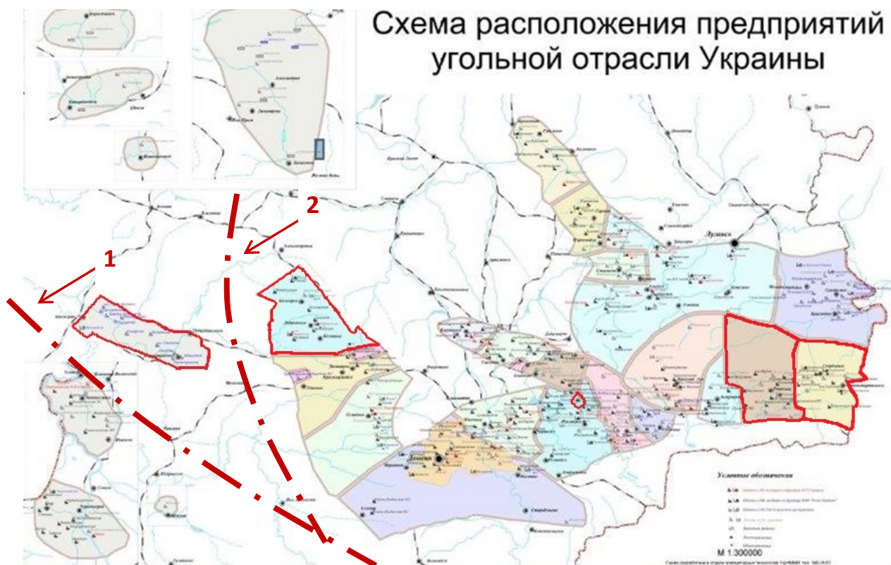
Рис. 1. Карта расположения угольных предприятий Украины и шахт компании ДТЭК Энерго (выделены красным цветом): 1 – граница зоны осадочных угленосных отложений; 2 – положение Криворожско-Павловского сброса
