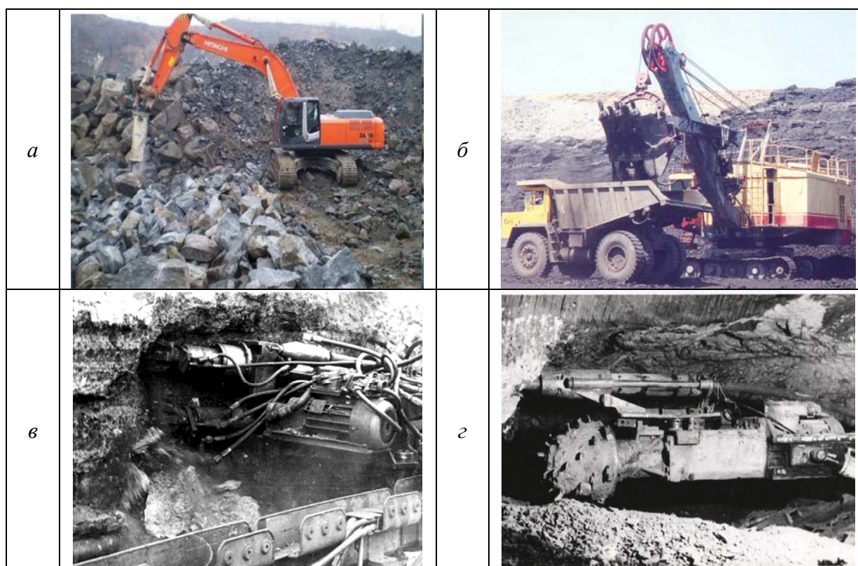
Рис. 1. Горные машины с активными исполнительными органами: а — экскаватор НІТАСНІ с навесным гидромолотом, б — экскаватор ЭКГ–5В с ковшом активного действия с тремя пневмомолотами, в — экспериментальный динамический струг, оснащенный тремя гидромолотами, г — проходческий комбайн ГПКС с пневмомолотом
