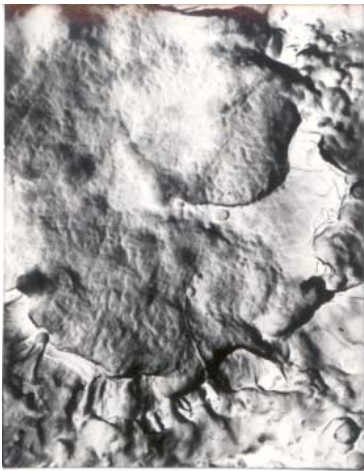
Рис. 1. Микрофотографии (увеличение \times 9000 ) резины В-14, модифицированной: а - СВМПЭ без добавок, б – СВМПЭ с добавками \beta -сиалона.
