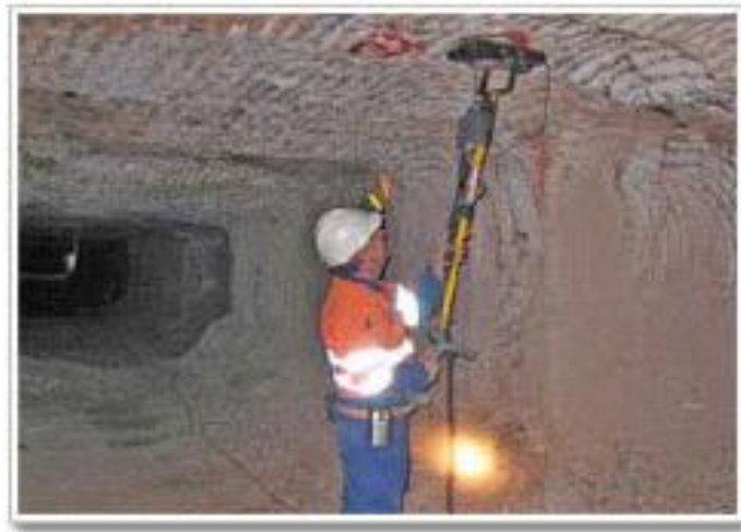
Рис. 1 Переміщення по поверхні середовища комплектної системи Ground-penetrating radar (GPR).
