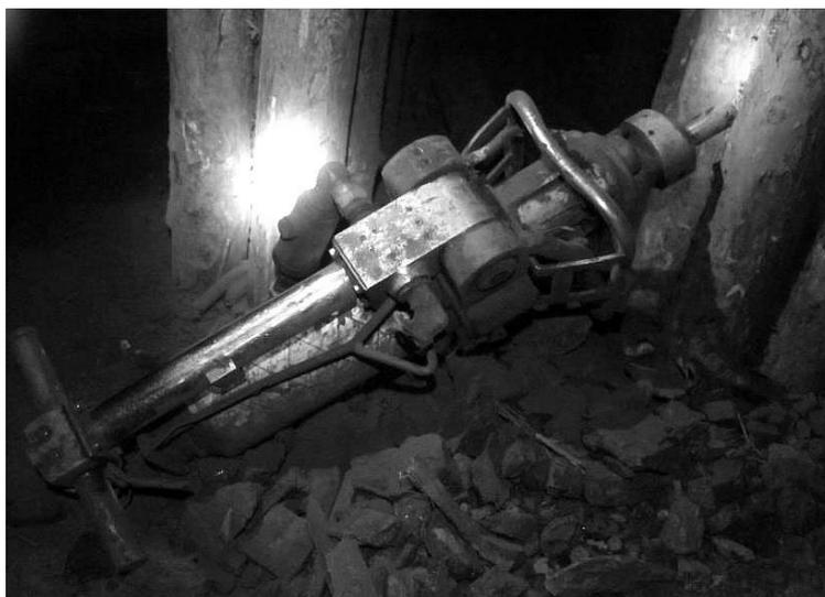
Рис. 4. Установка MQT модификации «А (mini)»
