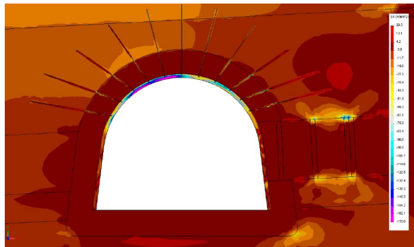
Рис. 8.8. Эпюра горизонтальных напряжений \sigma_x в комбинированной крепи выемочной выработки
