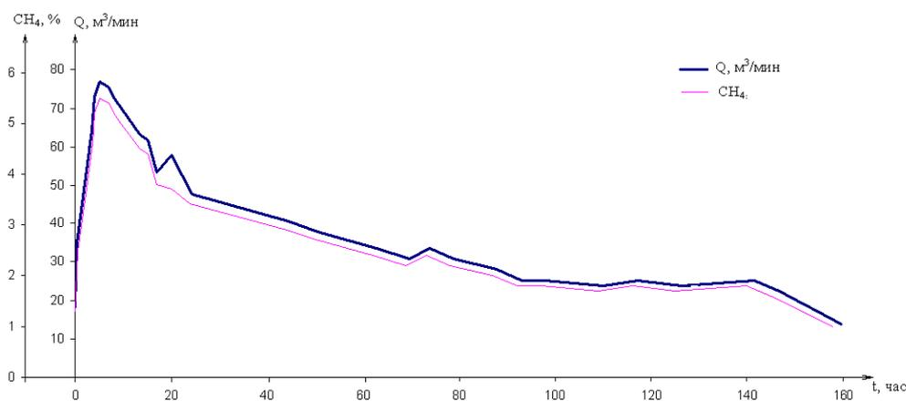
Рис. - 2 Динамика газовыделения на участке 2-й западной лавы пл.  $h_{10}^B$  шахты «Холодная балка»
