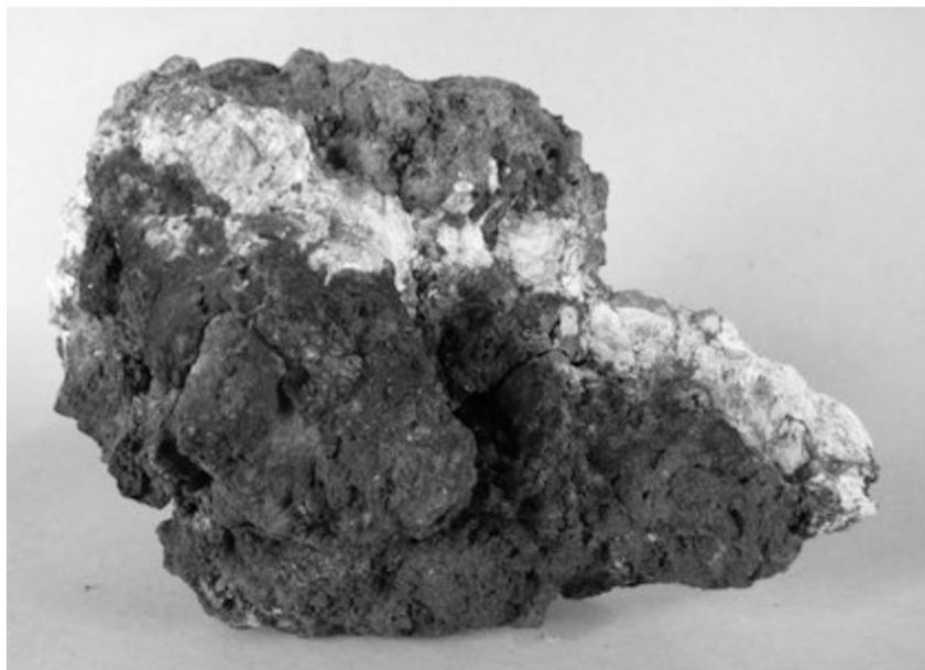
Рис. 1. Прослой алуниита (белый) на контакте марганцевой руды (черный агрегат, внизу) и надрудной глины. Образец ЗП 46, размер 13x9 см.
