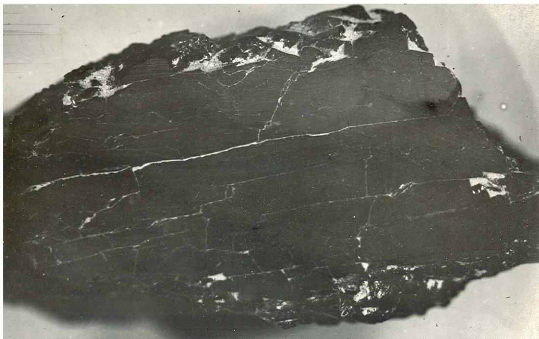
Рисунок 1 Штуф угля с декорированной (проявленной) трещиноватостью
