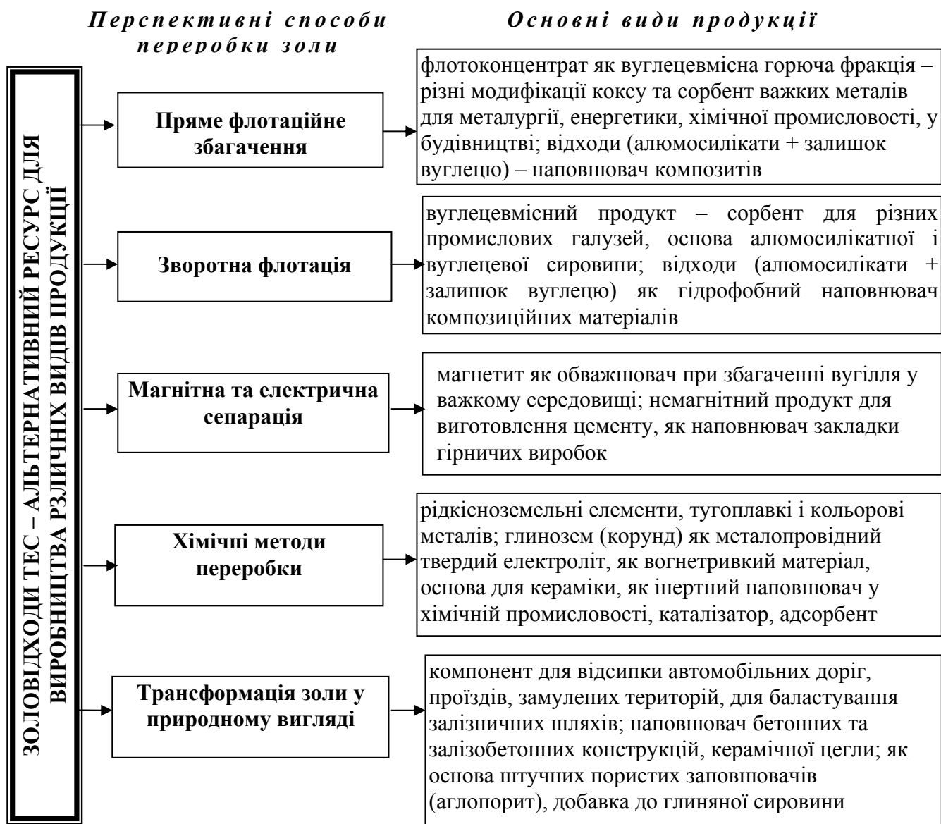
Рис. 1. Схема найбільш перспективних виробничих напрямків використання вторинних золовідходів ТЕС
