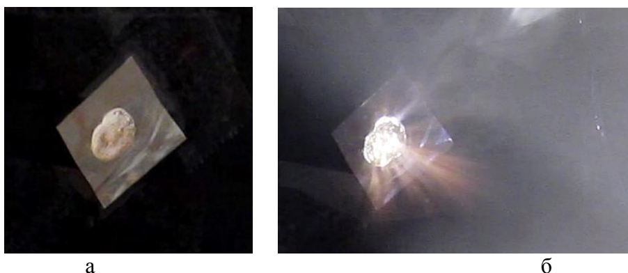
Рис. 1. Светочувствительное взрывчатое вещество на фольге (а), б – момент взрыва.
