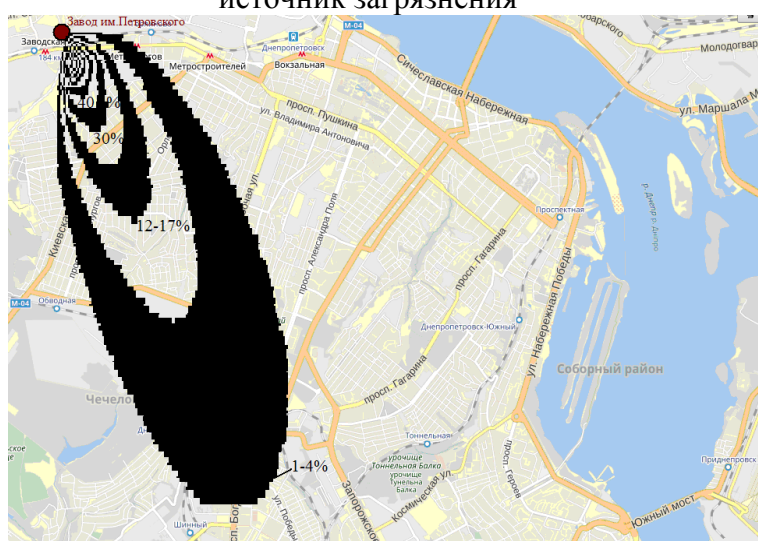
Рис. 2. Зона загрязнения диоксидом серы при направлении ветра с северо-запада \alpha=60^\circ , один источник загрязнения
