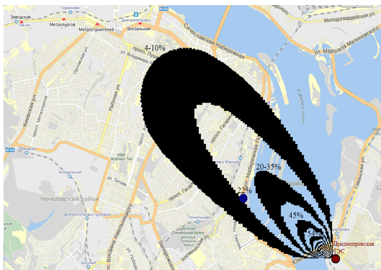
Рис. 4. Зона загрязнения диоксидом серы при направлении ветра с юго-востока \alpha=30^\circ , источник загрязнения – Приднепровская ТЭС
