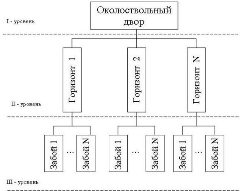
Рисунок 1 – Иерархическая структура транспортной модели шахты
