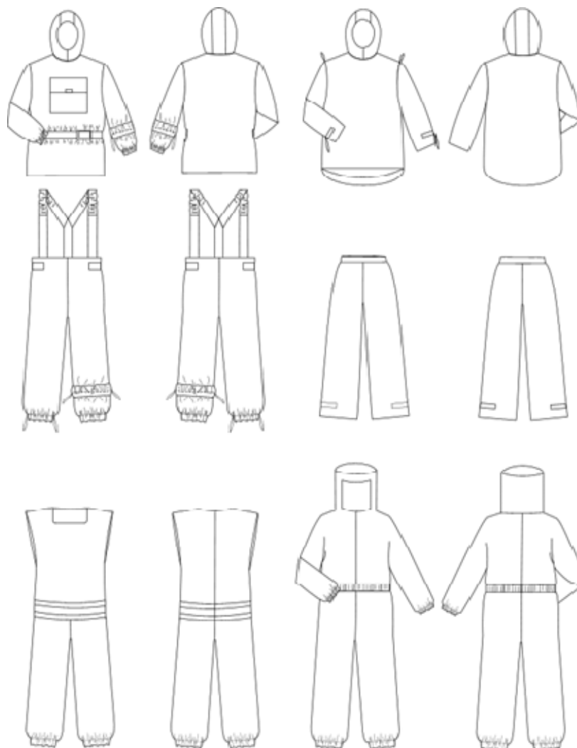
Рис. 2.18. Проектні різновиди комплектів ЗІЗ: а – костюм ізолювальний; б – костюм фільтрувальний; в – комбінезон ізолювальний; г – радіаційнозахисний комплект
