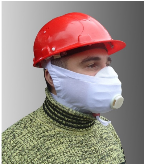
Рис. 2.9. Півмаска фільтрувальна з головним гарнітуром швидкого припасування (модифікація 1): 1 – корпус лицевої частини; 2 – головний гарнітур швидкого припасування; 3 – вузол клапана видиху
