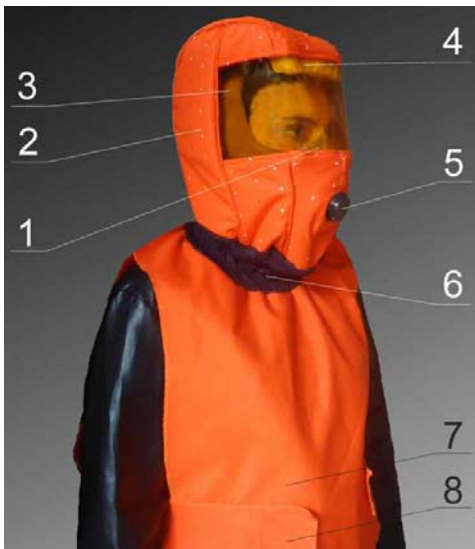
Рис. 5.11. Шолом термостійкий фільтрувальний: 1 – корпус лицевої частини з повітронепроникного матеріалу з додатковими фільтрами FM A2; 2 – термостійкий фільтрувальний шолом з фільтром B2E2K2P2; 3 – підшоломник; 4 – термоакумулюючі елементи; 5 – вузол клапана видиху; 6 – еластична манжета; 7 – пелерина; 8 – текстильна застібка
