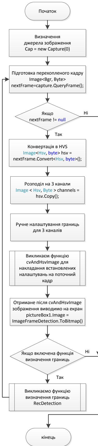
Рис. 2.12. – Блок схема алгоритму розпізнавання
