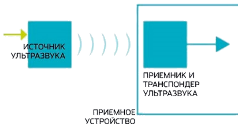
Рис 1.11. Схема передачи электроэнергии с помощью ультразвука
