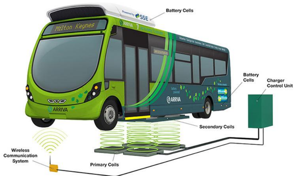
Рис.2.13. Схема беспроводной зарядки электрических автобусов, эксплуатирующихся в Милтоне, Великобритания.
