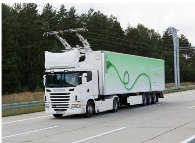
*Рис. 4. Использование электрической сети для питания электрического транспортного средства.*
