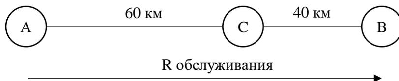
Рис. 3.1. Иллюстрация понятия «Радиус обслуживания» зарядной станции
