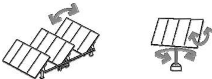
Рисунок 1.1 – одноосевые и двухосевые солнечные установки
