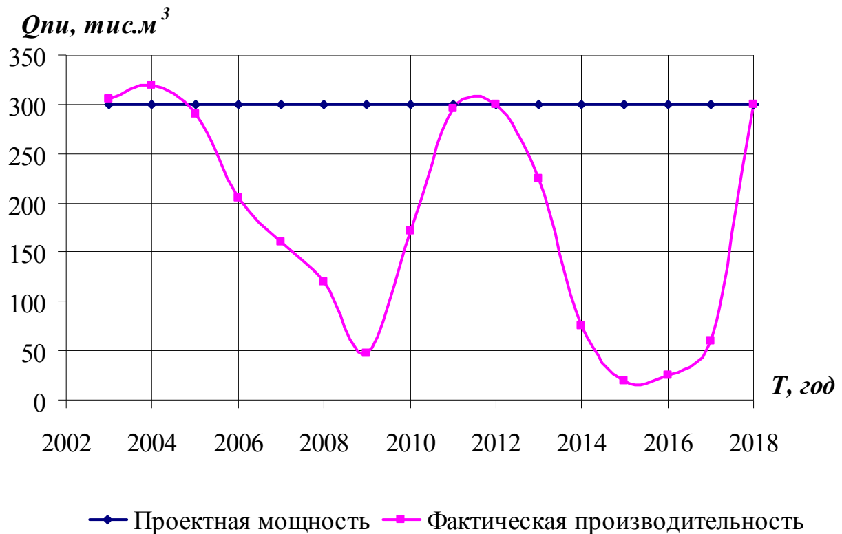
Рис. 2.2 – Анализ соответствия фактического выполнения вскрышных работ относительно рабочего проекта
