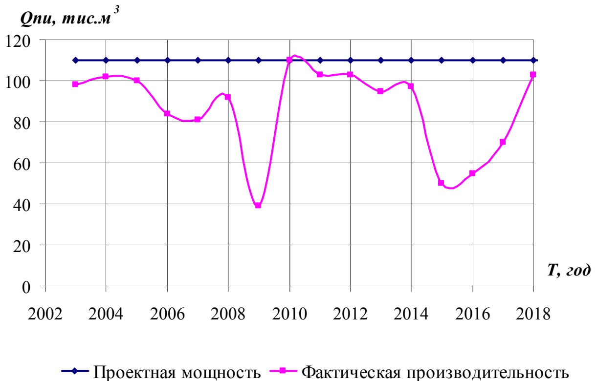
Рис. 2.1 – Анализ соответствия фактического выполнения добычных работ относительно рабочего проекта
