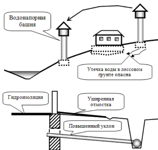
Рис. 2.7. Варіанти застосування різних інженерних заходів щодо зниження можливості розвитку просадки в лесових підставах
