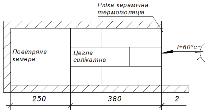
Рисунок 3.6 - Схема макета з встановленим рідким керамічним термоізоляцією (мікросфера)
