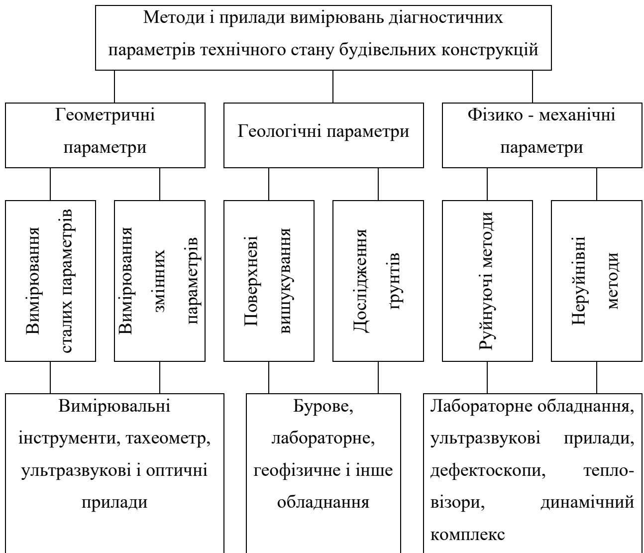
Рис. 1.3. Схема найбільш поширених методів і засобів вимірювань
