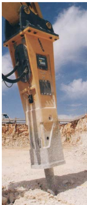
Рис. 2.16. Схема гідромолота для подрібнення негабаритних кусків породи: а – загальний вигляд; б – конструктивна схема: 1 – поздовжній штафт; 2 – контрольний клапан; 3 – акумулятор; 4 – верхня головка; 5 – поршень; 6 – циліндр; 7 – передня головка; 8 – піка
