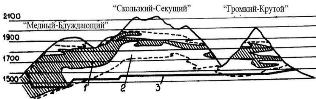
Рис. 5.7. Поперечний схематичний розріз Удоканського міднорудного родовища: 1 – рудні тіла; 2 – рудна зона; 3 – межа відкритої розробки
