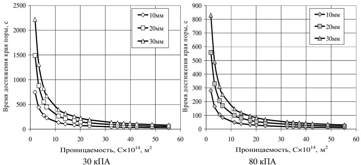
Рис. 3. Время перемещения границы раздела фаз при перепаде давлений
