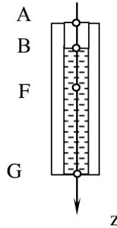
Рис. 2. Вытеснение воды из пористого тела поршневым способом
