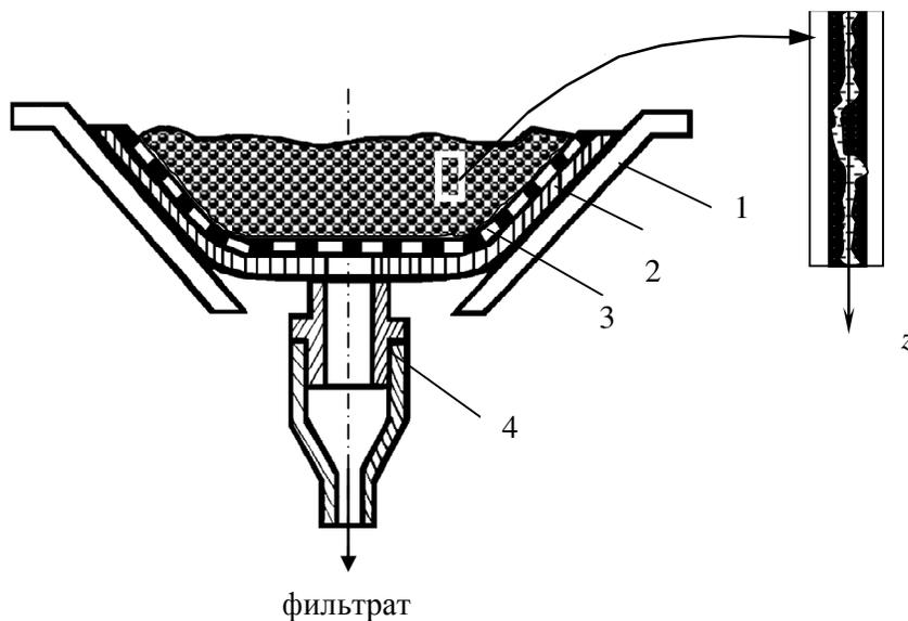
Рис. 1. Поперечный разрез ленточного фильтра
