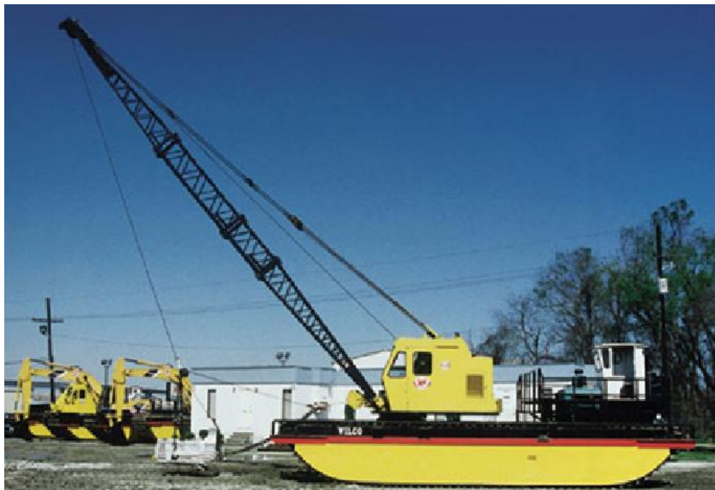
Рисунок 3.6 – Екскатор-драглайн WILCO Amphibious Dragline з понтонно-гусеничним приводом
