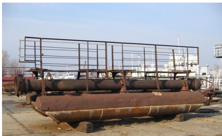
Рисунок 3.11 – Секція рефулерного пульпопроводу
