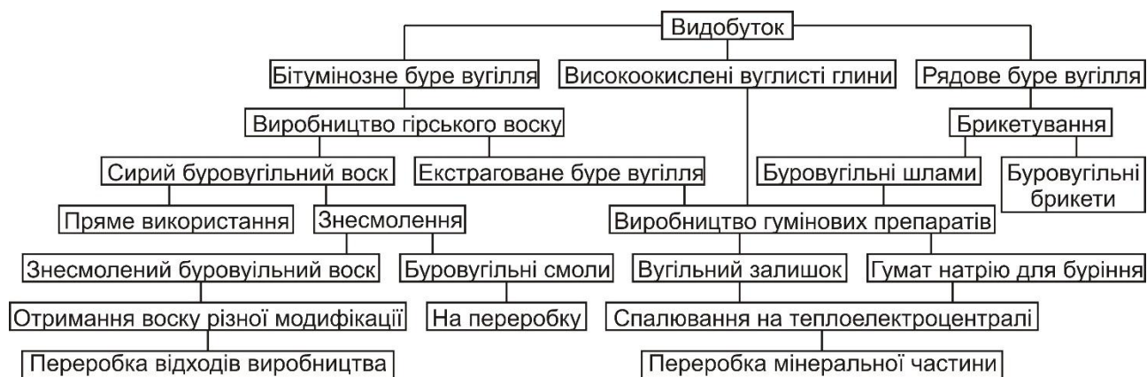
Рисунок 2.1 – Принципова схема комплексної переробки бурого вугілля
