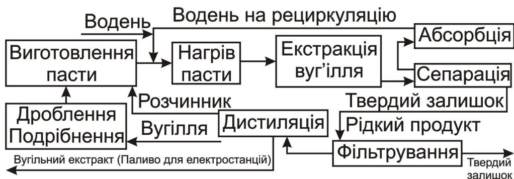
Рисунок 2.5 – Принципова схема виробництва палива з вугілля за методом «SRC»
