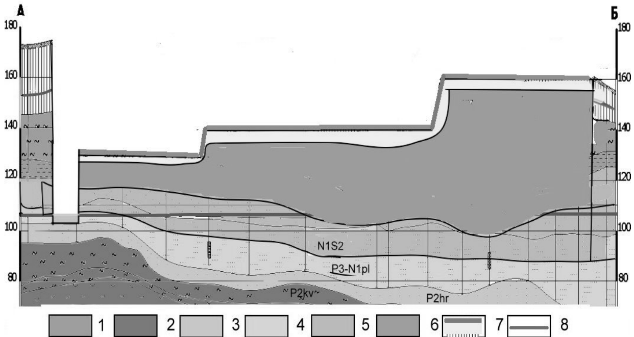
Рис. 1. Схематичні геологічні розрізи Мотронівсько-Аннівської ділянки до і після відпрацювання кар'єру. 1-породи кристалічного фундаменту, 2-відносно водотривкі породи кори вивітрювання, бучацького і київського ярусів, 3-піски харківського ярусу, 4-піски полтавської серії, 5-піски сарматського ярусу, 6-водотривкі глини, 7-суглинки лесовидні і родючий шар, 8-рівень підземних вод.
