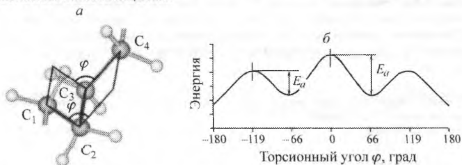
Рис. 1. Конформация молекулярной структуры угля (а) и характерная зависимость потенциальной энергии конформера от значения торсионного угла \varphi (б), где E_a — энергия активации конформационных переходов
