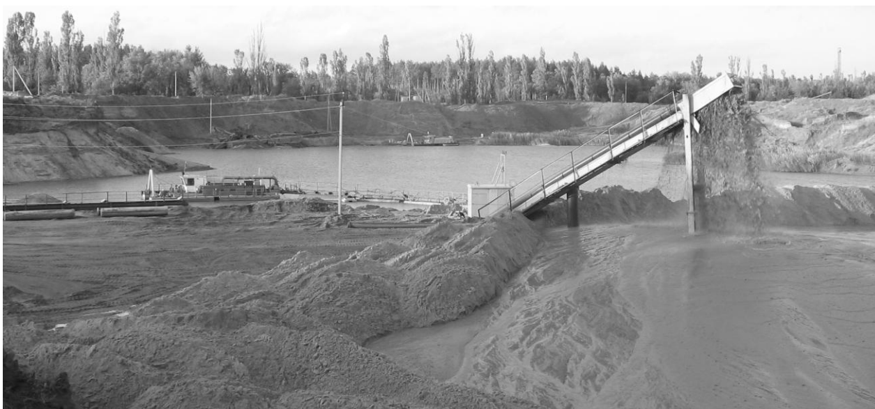
Рис. 3. Використання похилого грохоту для переробки піску
