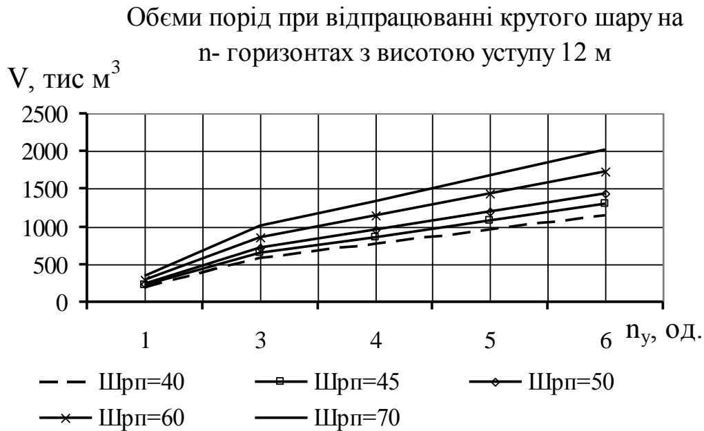
Рис. 2. Об'єми порід при відпрацюванні крутих шарів з висотою уступу 12 м: n – кількість уступів (горизонтів), що формують у крутому шарі
