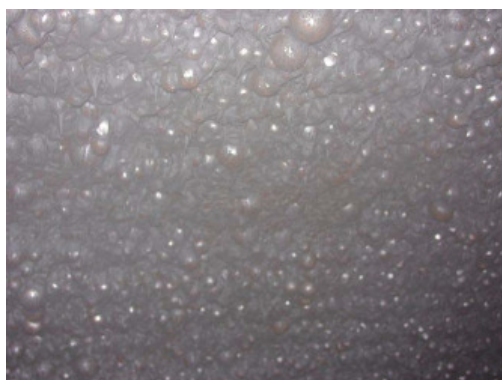
Рис. 6. MML с предохраняющим слоем из обломков шаров и магнитных минералов
