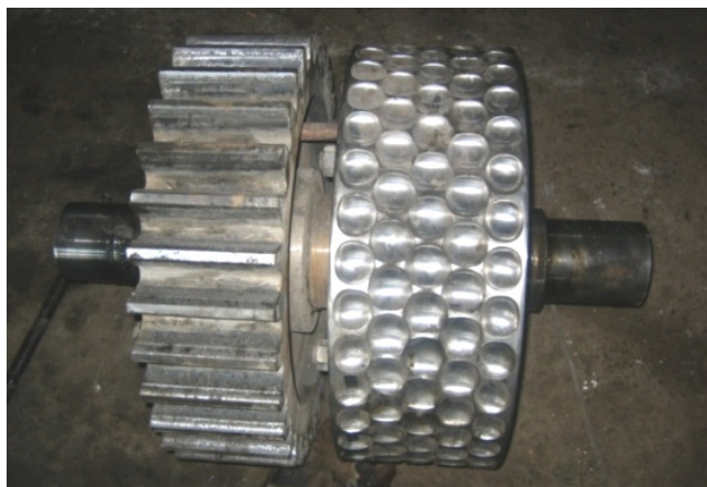
Рис. 3. Бандаж с изношенными формирующими элементами
