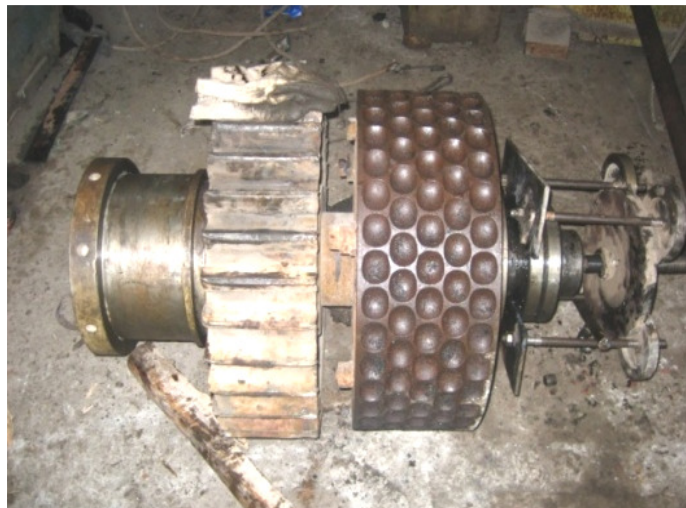
Рис. 2. Бандаж со стандартными формующими элементами
