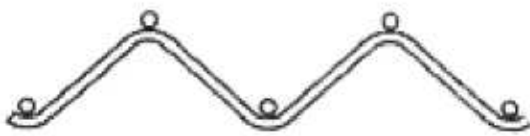
Рис.1 Шахтна міжрамна огорожа: а) загальний вигляд, б) вид зверху, в) в перерізах
